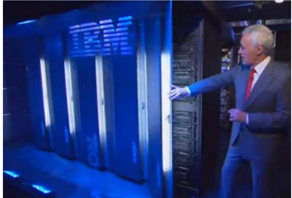
Watson v zákulisí (10 racků po 10 serverech IBM Power 750)
