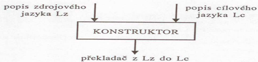
Obr. 1.12: Struktura dokonalého systému pro konstrukci překladače
